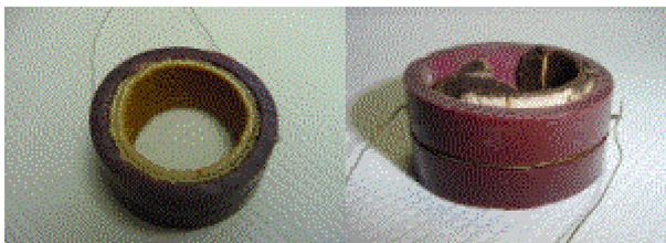
写真1 温泉配管の輪切りをピーカー内で電磁波照射
