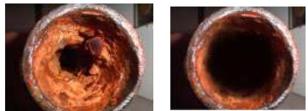
写真2 脱着可能な短尺管出口から見たスケール
